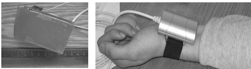
Рис. 4 – Внешний вид радара и способ его крепления.
