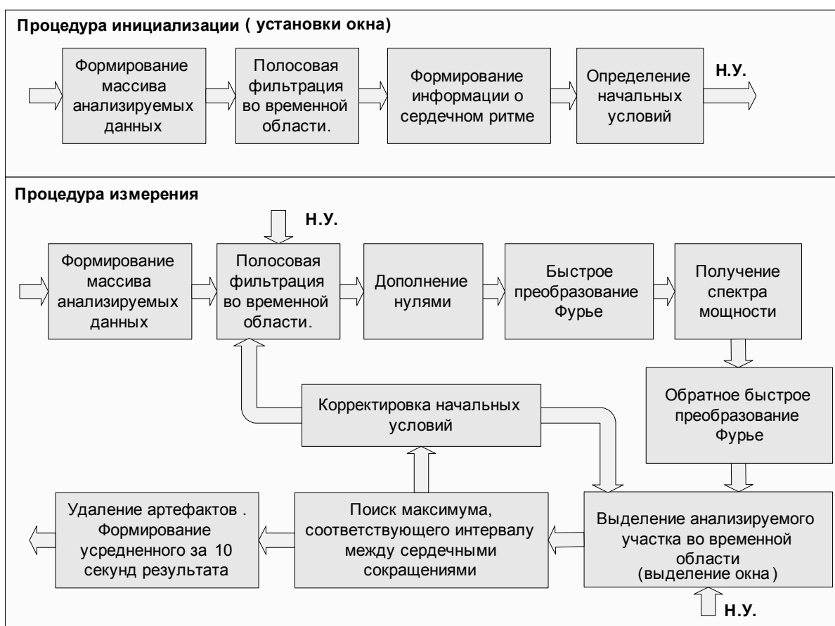
Рис. 5. Обобщенный алгоритм обработки методом двойного спектрального анализа
