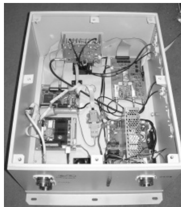
Рис. 2. Конструкция электронного модуля
